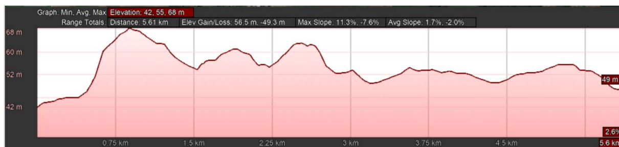
Joonis 6. Kaagvere – Roiu kavandatava survekanalisatsiooni kõrgusprofiil
