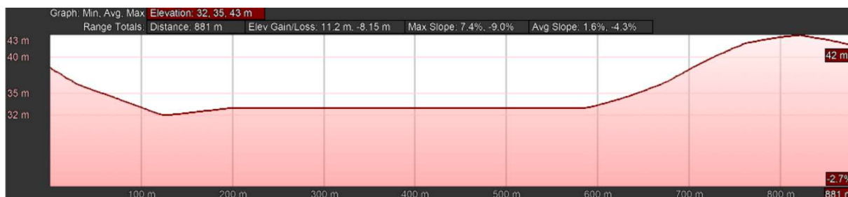
Joonis 5. Luunja Kaagvere kavandatava survekanalisatsiooni kõrgusprofiil
